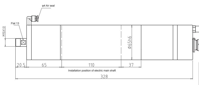
GDC65-15Z/0.8 0.8KW 220V 3.0A 250Hz 15000rpm
